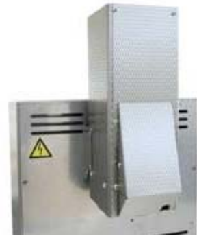
Катализатор для очистки органических составляющих отходящего воздуха. Органические составляющие подвергаются каталитическому сжиганию при ок. 600 °С, т.е., разделяются на углекислый газ и водяной пар. Таким образом в значительной мере исключается образование неприятных запахов. С помощью контроллера Р 330 катализатор можно переключать в зависимости от программы.
