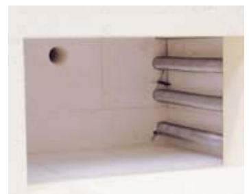
Внутреннее пространство печи с высококачественной изоляцией огнеупорным легковесным кирпичом
