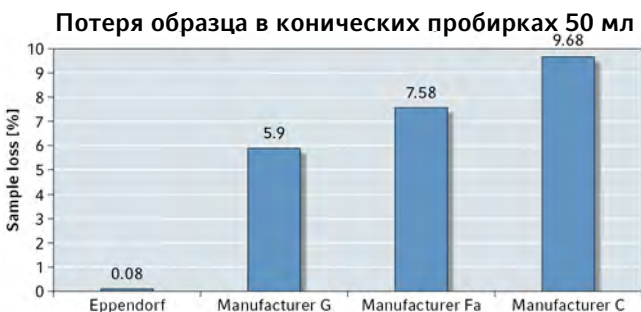
Рис.1: Потеря образца после 24 часов горизонтального хранения в разных конических пробирках 50 мл при температуре -86^{\circ}\text{C} . N = 50 конических пробирок Eppendorf 50 мл и 22 пробирки других производителей: G, Fa, C.
